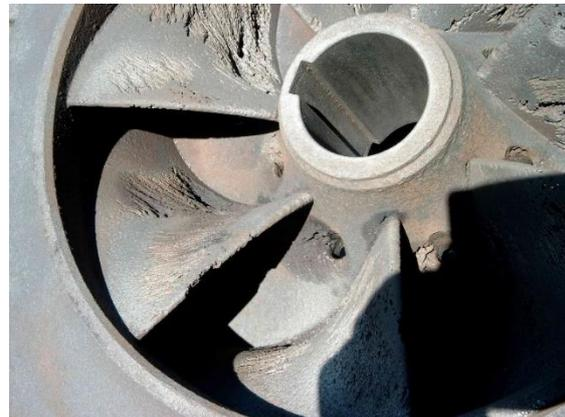
Abbildung 19 Kavitationsschäden
