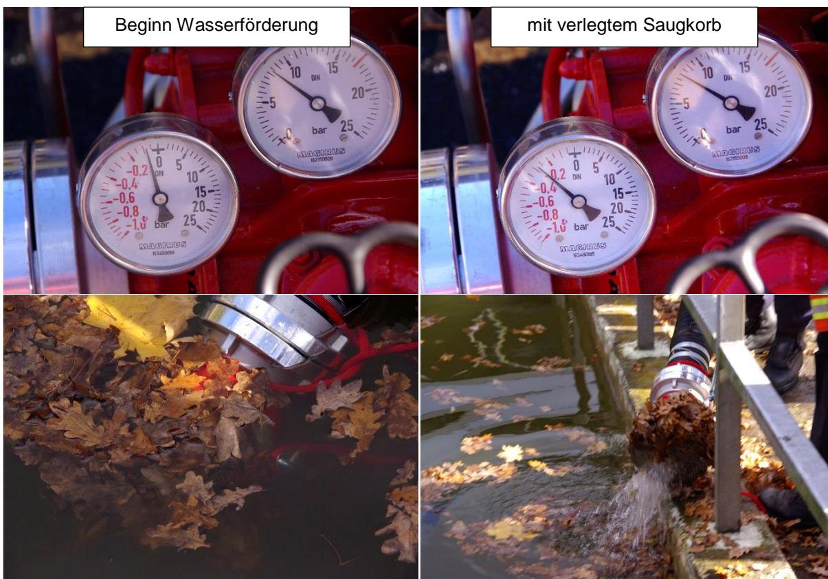
Abbildung 14 Manometer bei verlegtem Saugkorb
