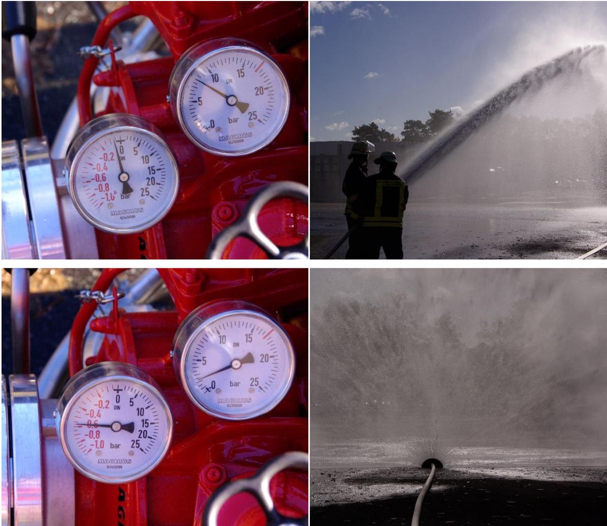
Abbildung 15 Manometer bei Erhöhung der Wasserabgabe
